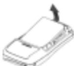
2 Retirez le couvercle arrière du téléphone, attrapez la partie saillante à l'extrémité de la batterie avec un ongle et soulevez-la.
