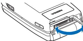
將記憶卡插入插槽。確認卡上的接觸點朝上，而且斜角處是朝向插槽。
