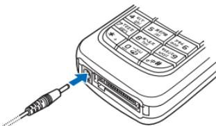
2. 將充電器導線插入行動電話底部插孔。
