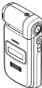
ในโหมดปิดฝาพับ จอแสดงผลบนหน้ากากด้านหน้าจะแสดงข้อมูลสถานะและนาฬิกา ในหน้าจอของโหมดสแตนด์บาย สัญลักษณ์แสดงความแรงของสัญญาณและระดับแบตเตอรี่, ข้อมูลเวลา, สัญลักษณ์แสดงสถานะ และชื่อของรูปแบบที่ใช้งานอยู่ (หากเป็นรูปแบบอื่นที่ไม่ใช่ **ทั่วไป**) อาจปรากฏขึ้น หากคุณกำลังใช้เครื่องเล่นเพลงเพื่อฟังไฟล์เสียงอยู่ แถบปรับระดับเสียงและข้อมูลแทร็คจะปรากฏขึ้น ใช้ปุ่มเลื่อนด้านข้างเพื่อเล่น หยุดชั่วคราว เล่นไฟล์เสียงไฟล์ถัดไป/ก่อนหน้า และเพิ่มหรือลดระดับเสียง
