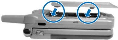
Luruskan penutup belakang pada telepon dengan penahan penutup yang sejajar ke slot pada telepon. Dorong penutup belakang ke arah atas telepon hingga terpasang penuh pada tempatnya.
