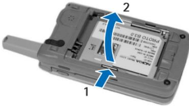
Pasang kartu UIM ke dalam dudukannya (bagian bersudut miring dimasukkan terakhir) dengan kontak berwarna emas menghadap ke bawah, menyentuh bagian berwarna emas pada telepon
