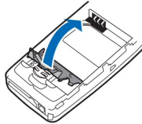
3. Pasang kartu UIM ke dalam tempatnya (sudut miring terlebih dahulu) dengan bidang kontak berwarna emas menghadap ke bawah, menyentuh bidang kontak berwarna emas pada telepon
