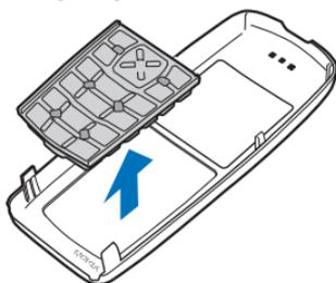
1. Lepaskan alas tombol dari penutup depan yang lama, kemudian pasang alas tersebut ke dalam penutup depan yang baru seperti pada gambar.
