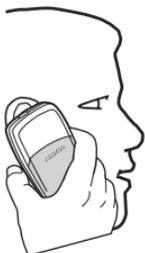
Telepon Anda dilengkapi dengan antena dalam yang terletak di bagian atas telepon. Pegang telepon seperti jika Anda memegang telepon biasa dengan antena mengarah ke atas dan melewati bahu Anda.
