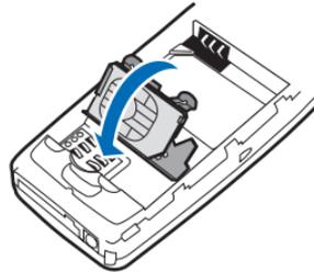
Bidang kontak berwarna emas pada kartu UIM akan menyentuh bidang kontak berwarna emas pada bagian dalam telepon.
