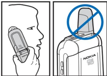
Perangkat Anda dilengkapi antena tetap yang terletak di bagian atas telepon bila flip tertutup. Pegang telepon dengan antena menunjuk ke atas dan melewati bahu Anda.
